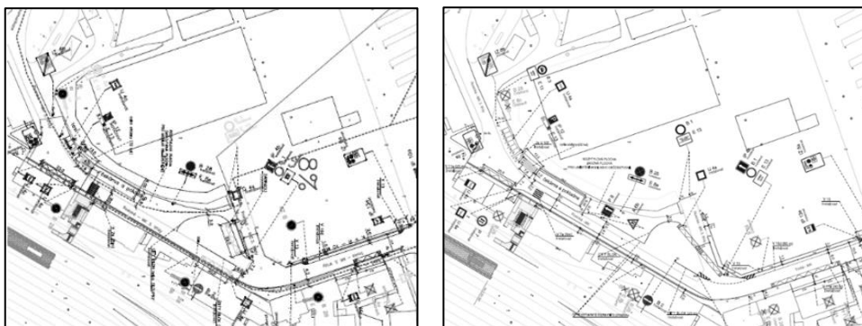
Obr. 2 – Brno-Dolní nádraží – Porovnání a) původního návrhu, b) nového finálního dopravního řešení, které bylo optimalizované opakovanými simulacemi [1].
