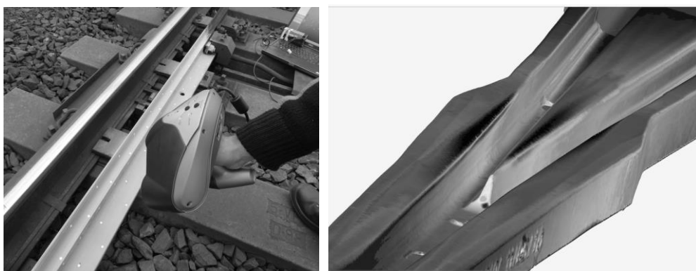
Obr. 3. 3D skener HandySCAN EXAscan a jeho grafický výstup po vyhodnocení [7]
