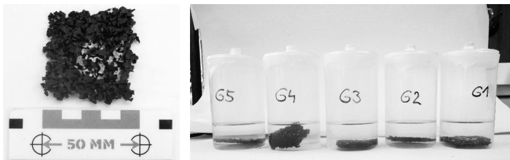
Obr. 1. Vlevo: vzorek pojeného gumového, vpravo: vzorky naložené v destilované vodě pro charakterizaci výluhů
