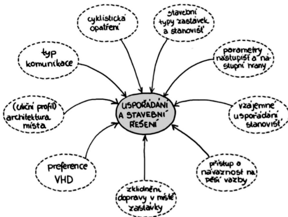
Obr. 4. Aspekty a požadavky vstupující do řešení prostoru zastávky. (zdroj: Standard zastávek PID [12])
