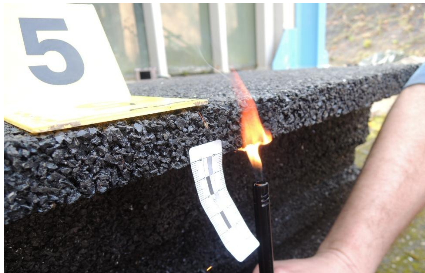
Obr. 4 Zkouška působení malého plamene na přední hranu clony.
