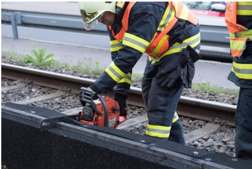
Obr. 5 Pokusné rozřezání clony řetězovou motorovou pilou.
